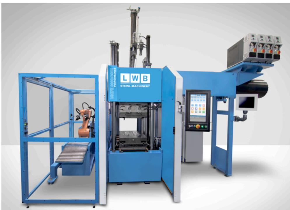
Ein weiteres LWB-Messeexponat wird eine Vertikalmaschine mit 4-Holm-Schließereinheit vom Typ VS EFE 3000/4000 sein.
