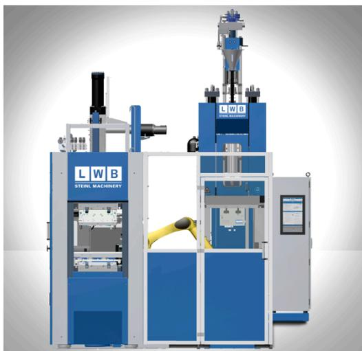
LWB-Steinl präsentiert auf der DKT eine verkettete Produktionsanlage in der eine VCRS 500/115 C-Rahmen-Maschine mit Thermoplast-Spritzaggregat im Verbund mit einer VRF 1100/160 Portalrahmen-Gummi-Spritzgießmaschine vollautomatisch einen Kunststoff/Gummi-Verbundteil herstellen.
